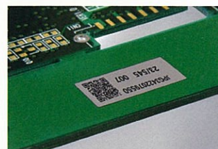
電子基板の工程管理 2次元コード等での情報表示
